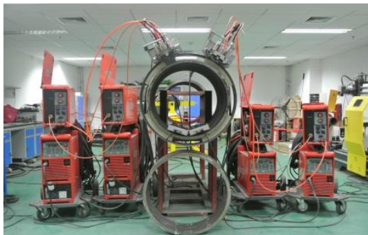
油气管线铺设双炬自动焊接样机系统
