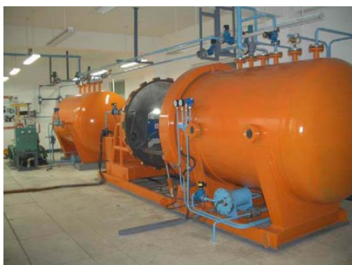
国内最大的水下干式高压焊接工艺试验系统
